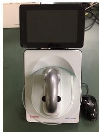
1 - 2  $\mu$ Lのサンプル量のDNA、RNA、タンパク質を数秒で正確に定量できる装置です。
