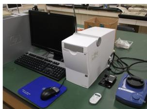
DNA, RNA, タンパク質の電気泳動解析で濃度、サイズ、品質などの情報をデジタルデータとして得ることができる装置です。
