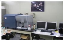
細胞自動解析分取装置(セルソーター)
