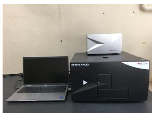
6~384穴プレートの吸光、蛍光、発光の測定が可能な装置です。
