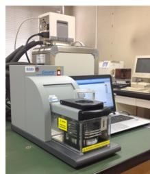
高出力で安定した一点集中型の超音波を発生し、動物組織、細胞などの破碎、溶解などを実行できます。
