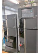
液体試料に溶解した成分を分離し、定性、定量分析する装置
