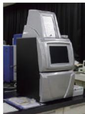
EtBrなどで染色されたゲル内のDNAをLEDライトによって検出する装置
